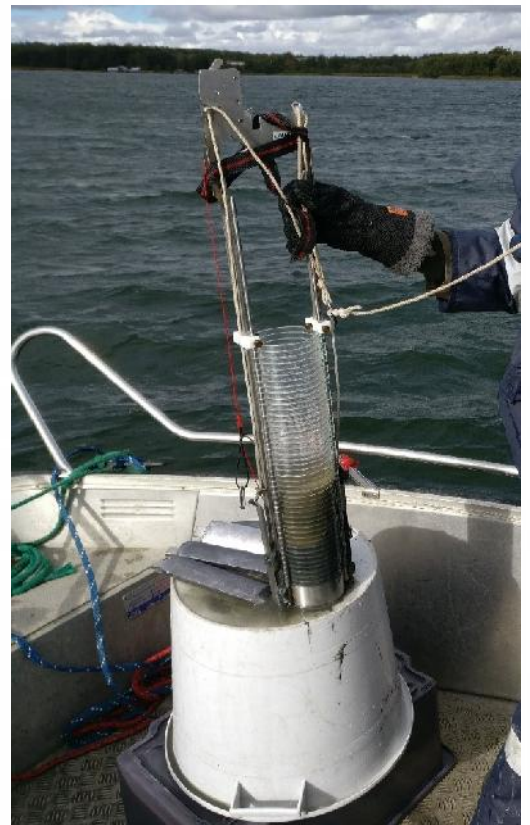
Joonis 7.3. Limnos südamikuproovide võtmise vahend. Foto: Lauri Äystö, SYKE.
